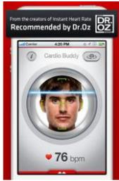
知面知心是由美国杨百翰大学电气工程博士 Jack Gunther 和犹他州立大学电气工程学硕士 Nate Ruben 共同研究的项目。基于 KLT 算法，通过摄像机可以低成本大量的收集血液信息并分析，通过侦测实验者的额头，发现可以将额头区的像素用算法运算，通过皮肤细微的变化算出心率的变化。
